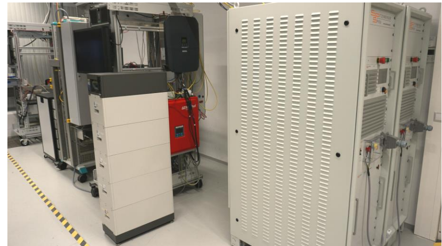
Bild 19 Die BYD Battery-Box Premium HVS 12.8 wurde vom Karlsruher Institut für Technologie (KIT) in Kombination mit dem Hybridwechselrichter KOSTAL PLENTICORE G3 M 10 getestet. Rechts im Bild sind die beiden PV-Simulatoren dargestellt, die die Strom-Spannungs-Kennlinie einer PV-Anlage nachbilden (Bild: KIT).
