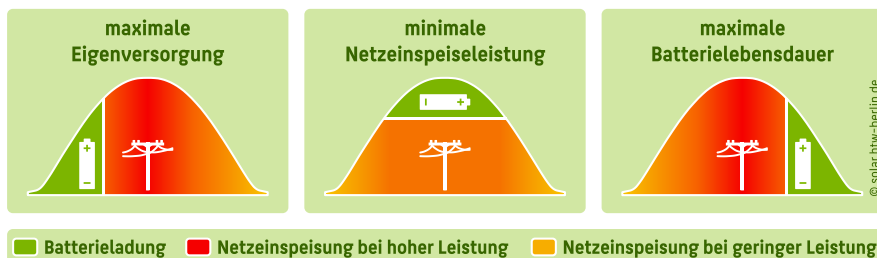
Bild 53 Tageszeitlicher Verlauf der Energieflüsse von PV-Batteriesystemen mit unterschiedlichen Ladestrategien und Optimierungszielen. Die Batteriespeicher entfalten ihr größtes Netzentlastungspotenzial, wenn sie vorrangig mittags laden.
